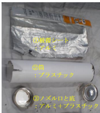
写真1 接着剤(変成シリコン)の解体状況
