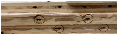
写真3 試験体解体後 CLT 小口の状況 （一番上：DP 仕様，下2つ：DP+SPL 仕様）
