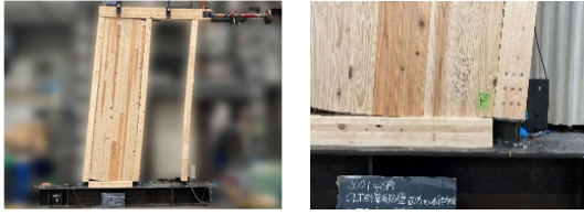
写真1 CLT10H 最終変形時（全景と柱脚）
