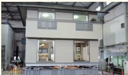
西松建設(株)技術研究所3軸振動台を利用した実大振動実験。
